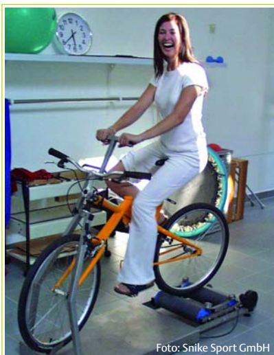
Abb. 4 Wenn das Fitnessrad auf der Rolle fixiert ist, bringt der Benutzer das Hinterrad selbst in Schwingung.
