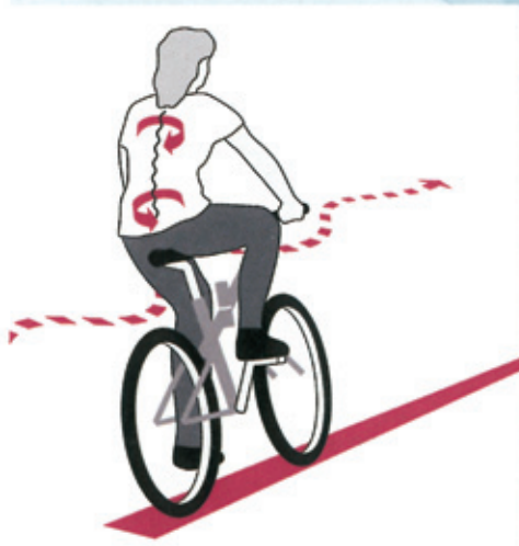
Die Kreuzgang-Gegenrotation stabilisiert den Geradeauslauf. Im Rollenstand führt die selbe Bewegung zum angestrebten „Wedeln“.
