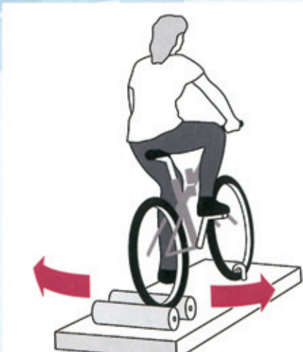
Die Kreuzgang-Gegenrotation stabilisiert den Geradeauslauf. Im Rollenstand führt die selbe Bewegung zum angestrebten „Wedeln“.
